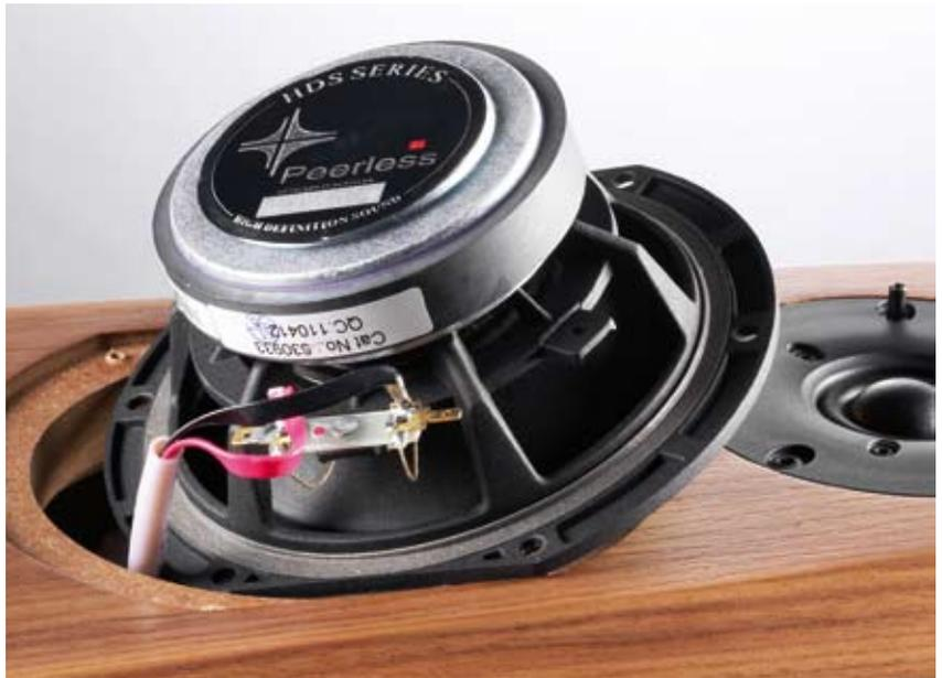
**FÜR KENNER DER MATERIE:** Die Tiefmitteltöner stammen von Peerless aus der noblen HDS-Serie. Die hochwertige Innenverkabelung steuert Wireworld bei.
